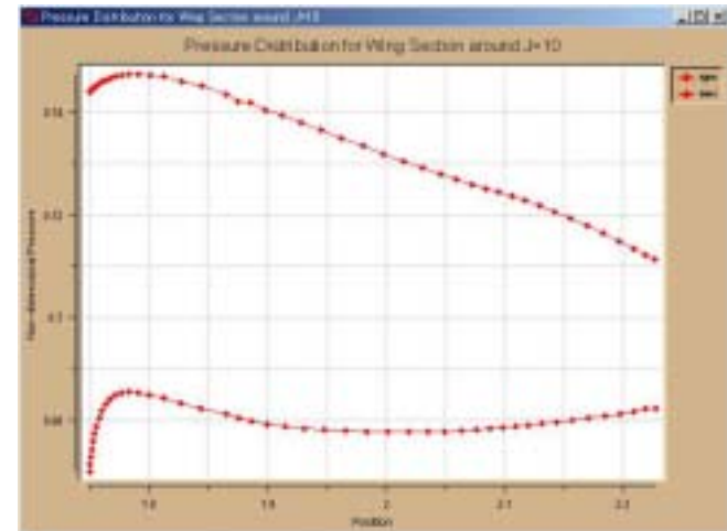
翼上面および下面の圧力分布 ( J = 10 ) 横軸: 前縁部からの距離 縦軸: 圧力
